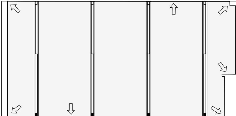
Staubschutzwand aufstellen und Folie an allen Seiten mit geeignetem Klebeband befestigen.
