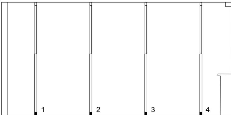
Zum Einrichten der Staubschutzwand die Teleskopstangen an der endgültigen Position ohne Folienwand aufstellen.
