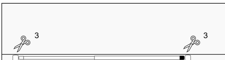
Vor und nach den Teleskopstangen jeweils eine C-förmige Öffnung aus der Folienschlaufe schneiden (3). So erhalten die Teleskopstangen am Aufstellungsort direkt Kontakt mit Wand und Boden.
