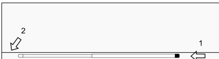
Folie in Längsrichtung ausbreiten und die Teleskopstangen in die Folientaschen einschieben (1). Dabei die Reihenfolge der Stangen beachten (siehe Bild 1).
