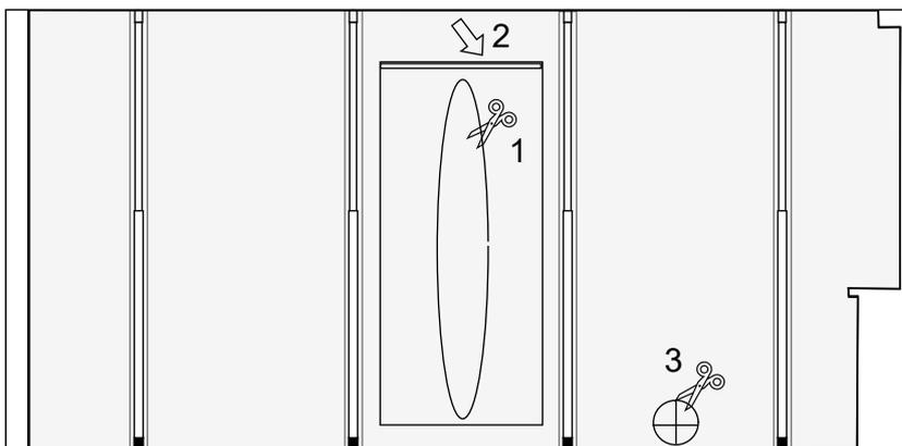
1. Mit der Schere eine Öffnung als Durchgang in die Folienwand schneiden.
